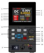
1.输出状态显示: "OFF"表示当前输出关闭: "CV"表示当前输出为恒压状态: "CC"表示当前输出为恒流状态: "OVP"表示发生了过压保护输出中断: "OCP"表示发生了过流保护输出中断。
